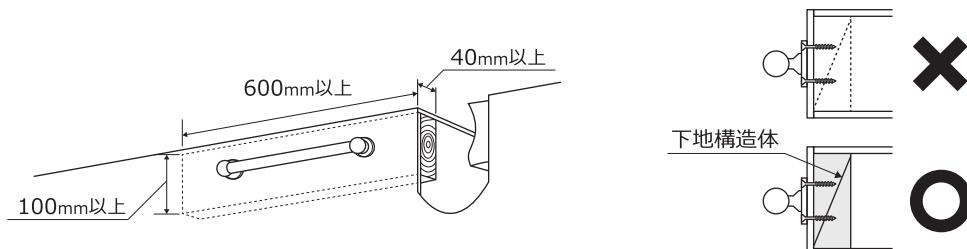
※構造体の設置寸法は現場ごとに異なりますので、必ず取付け部分が使用重量に十分耐えられるか確認してください。
