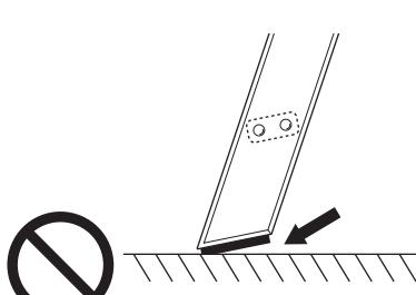
はじめからはしご下部が70度にカットされていますので、水平器などで調整して設置してください。
