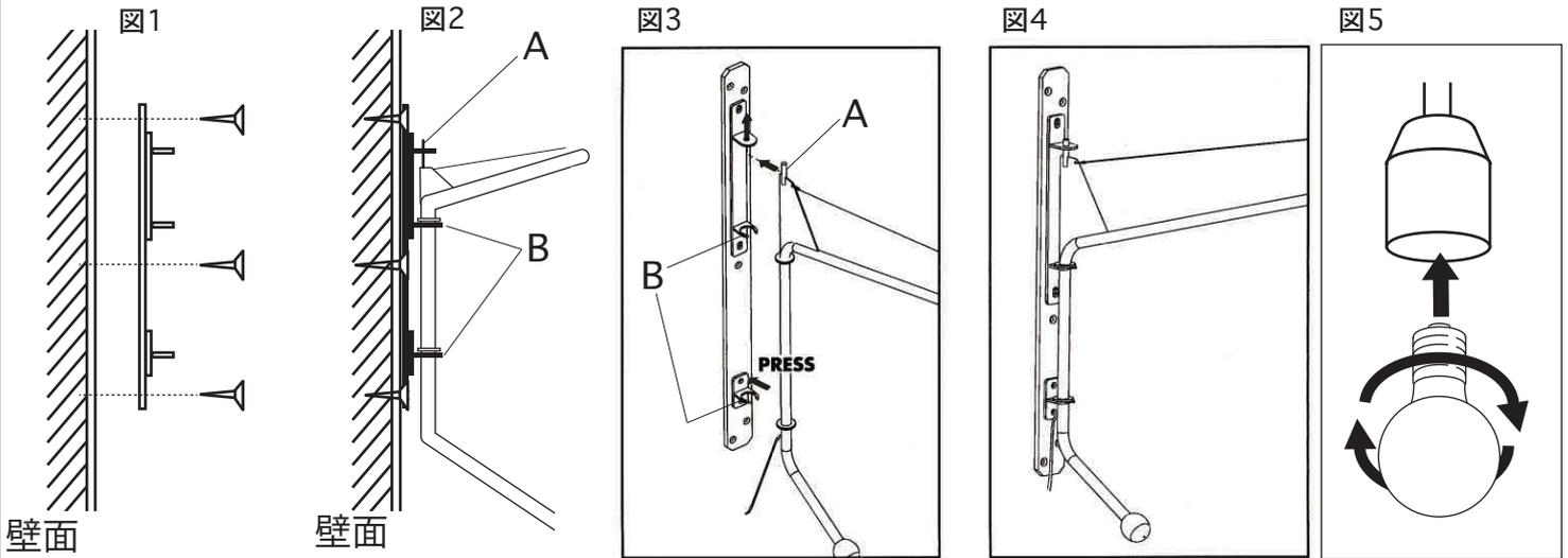
1. 取り付け金具を壁面に取り付けます。(図1参照) コンセントが近くにあるか確認してください。図3を参考に取付け金具の上下を間違えないように、注意して行ってください。壁面に柱など補強が入っている場所を選び、壁面材に最適なネジを別途ご用意して取付けてください。しっかりと固定されていないと外れる恐れがあり大変危険です。取り付けに不安がある場合は、専門の業者に依頼してください。
