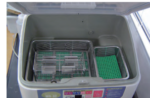
図3 汚染テストピース(非露出部)の設置方法(WD-32)
