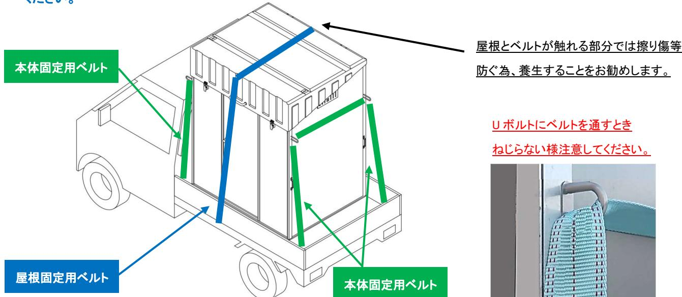
使用する車両の構造や路面状態などにより固定箇所の変更や追加、走行中のこまめな点検を実施してください。
