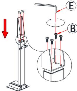
中継板③をリフトポスト②の先端に取り付ける、4本のボルトBでロック固定する。
