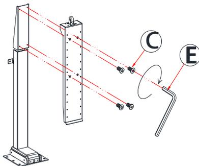
図のように:固定座④を4本の皿ネジCと中継板③でロック固定する。
