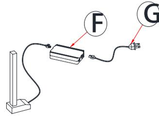
電源線Gとモータ線をそれぞれコントローラF上の対応する位置に挿入する。
