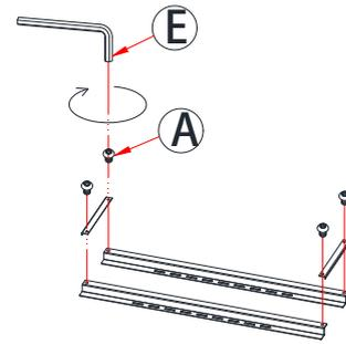
図のように:横梁⑤とサイド固定板⑦を4本のボルトAでロック固定する。
