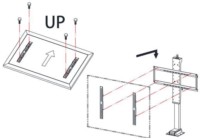
図のように:まず2本のテレビ固定板⑥(フック口はテレビの底に向かって)を対応する穴位置に合わせます、テレビの持参したネジでそれぞれ本体にロックする、また固定板は2本の横梁に同期して掛けられている。
