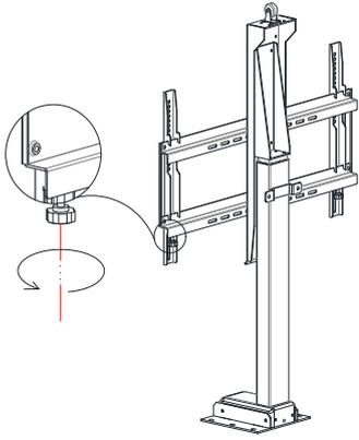
図のように：2本の梅ネジを締めて固定し、フックの緩み脱落防止。
