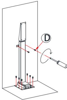
図のように:8本の十字ボルトDで台座①とリフトポスト②をそれぞれ固定する。
