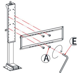
ステップ5で取り付けられたフレーム(テレビのサイズに合わせて高さを決定する)を4本のボルトAと固定座④でロック固定します。
