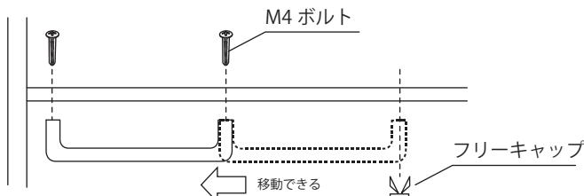
マルチラックは移動させることができます。M4ボルトとフリーキャップを外し、好きな場所に移動させます。移動させた後は、M4ボルトを締め、空いた穴には、必ずフリーキャップを付けなおしてください。
