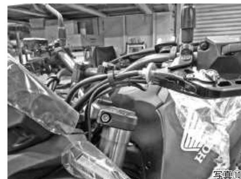
グリップヒーターハーネスと電源ハーネスを接続後に配線接続部（ギボシ端子部）は配線テープなどを巻きつけて、念のため防水処理を施します。
