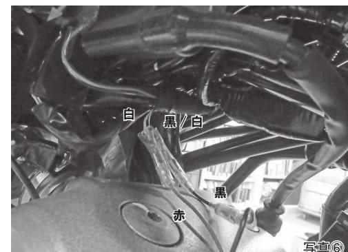
\*配線を間違って、逆に接続した場合、車両をキーONにしただけで、制御スイッチの電源が入っていないのにグリップが暖り始めますのでご注意ください。
