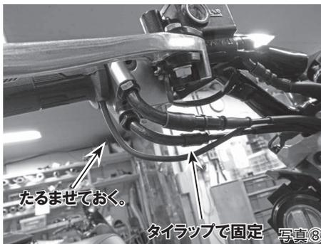
左側グリップヒーターとスイッチの配線は写真⑨を参考にしてカバー下部に沿わせながら、グリップヒーターハーネスのカブラーに接続します。
