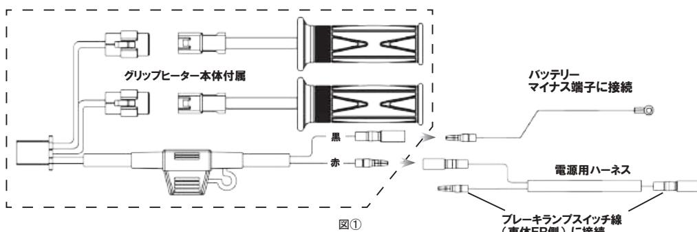
それぞれの配線を接続したら、左右グリップ、スイッチを仮接続してグリップヒーターの動作確認をしておきます。
