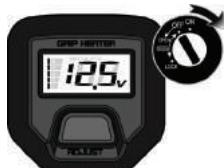
イグニッションキーをONの位置に回すと、LEDバックライトが点灯し、電圧を表示します。
