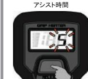
下限電圧設定から、さらにボタンを3秒以上長押しすると、スタートアシスト時間の設定画面に入ります。その後にボタンを短押しすると時間(分)が変わります。
