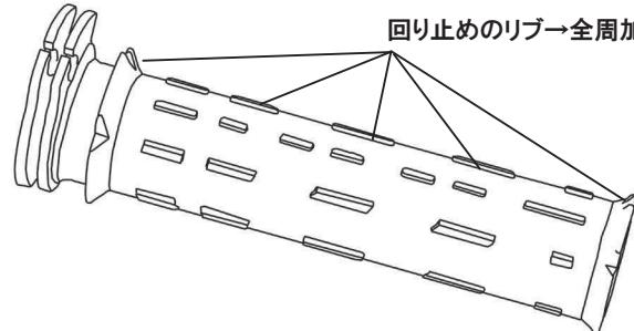
ご自身で加工される場合、リブを削った後に一旦、接着剤は使用せずにグリップヒーターを差し込んで確認してください。手で差し込んでちょっときついくらいで、外そうとすれば外せるくらいならば、グリップヒーターのケーブルの角度、位置を確認し、接着剤を使用して取り付けしてください。
