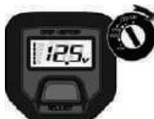
イグニッションキーをONの位置に回すと、LEDバックライトが点灯し、電圧を表示します。
