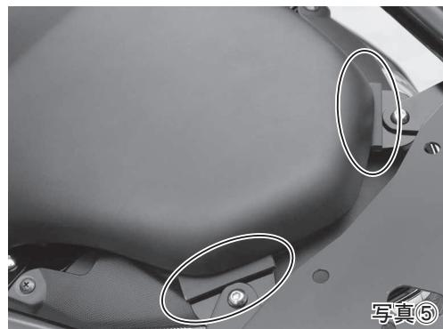
⑥ 写真⑥を参考にしてベースプレートを取り付けします。
