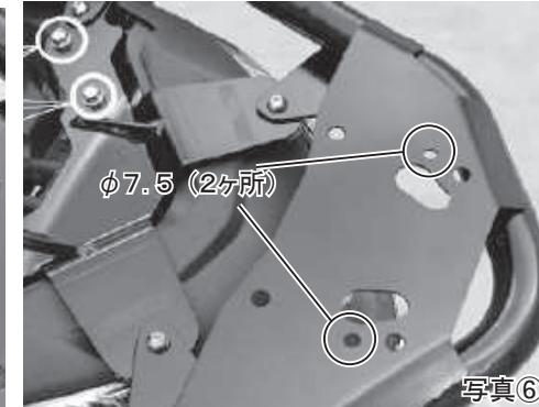
⑥ 写真⑥で○印で囲まれたφ7.5の穴を使い、パックレストを付属のM6ボルトで2ヶ所下から組み付けて規定トルクで締め付けます。(写真⑦)
