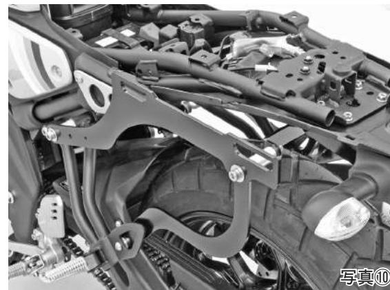
7. 全てのボルト、ナットの締め付けが完了したのち、リアフェンダー、シートなどを元へ戻して完成です。
