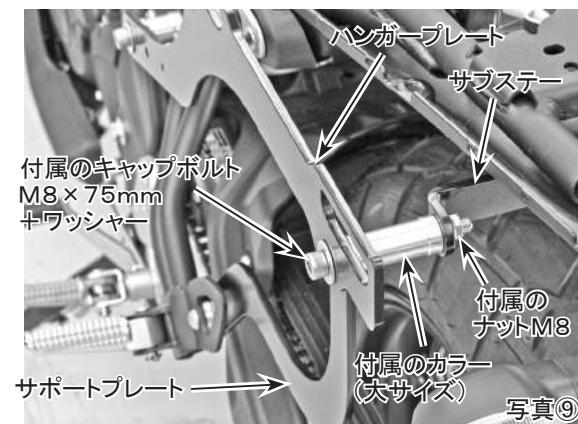
6. 全ての仮止め部分をクリアランス、位置調整しながら規定トルクで締め付けます。
