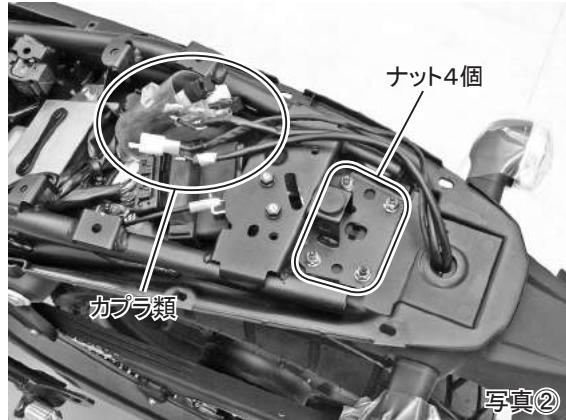
3. 前項2で取り外したリアフェンダーに、付属のサブステーをセットします。
