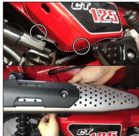
スクリュー1本と、トリムクリップ（短）1本を外し、右ボディカバーを外します。
