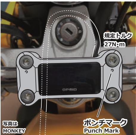
アッパーホルダーのポンチマークをフロント側に向け、純正キャップ4個、純正ソケットボルト4本を利用取り付ける。ポンチマーク側のボルトから締め付ける。キーシリンダーの前方にコードを回し、メインハーネスに沿わせる。
