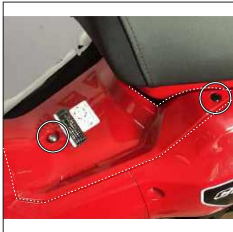
1本のスクリューとトリムクリップ（長）を外し、センターカバーを外します。
