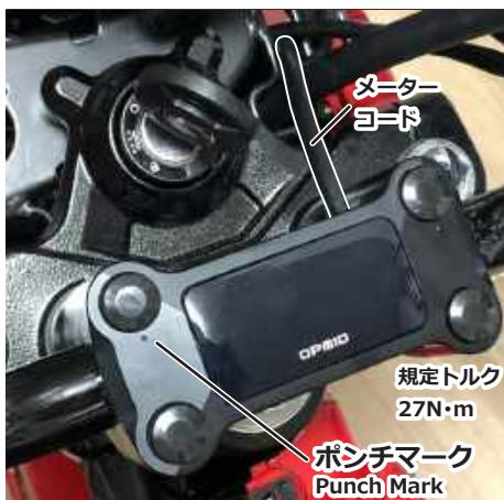
アップホルダーのポンチマークを前方に向け、純正ソケットボルト4本を再利用して取り付けます。
