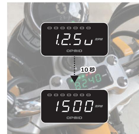
キーを回すと、まず電圧計を表示してからタコメーターに切り替わります。
