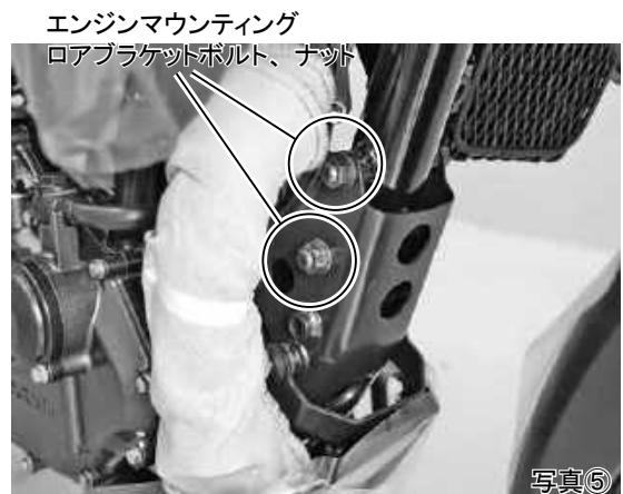
※エンジンマウンティングロアブラケットボルトを取り外すときはオイルクーラーを軽く引いて外します。
