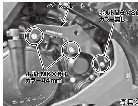
4. 最後にスライダー部を付属のボタンボルトM6×25を使用して、取り付けを行います。各部のクリアランスを確認しながら、規定トルクで締め付けます。
