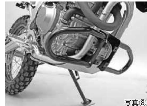
・スキッドプレートの取り付けが終わったら、連結プレートを取り付けして完成です。(写真⑨)
