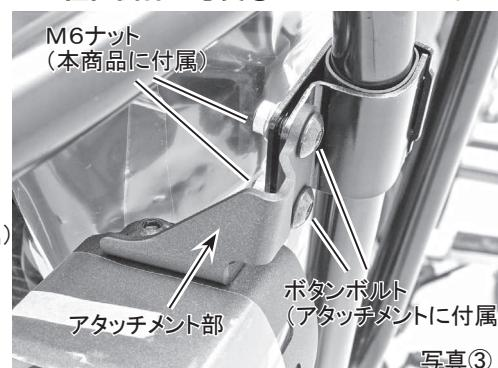
3. カウルやカバーにフォクランプなどが干渉していないことを確認して、前項2で仮止めしたM6ナットを規定トルクで締め付けます。(写真③)
