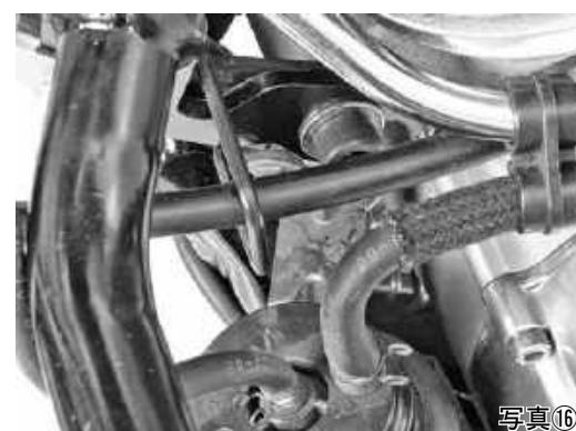
6. サブステーと左側エンジンガードを付属のM8×25ボルトとナットで仮止めします。
