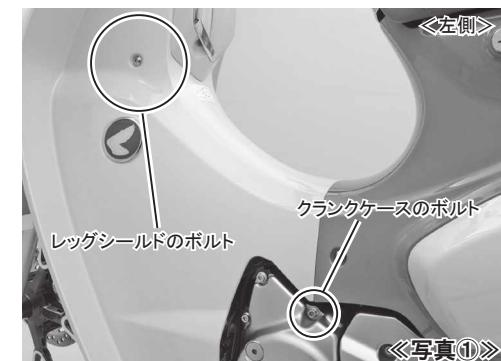
2. 車両右側のレッグシールドと、クランクケースのボルトを各1本づつ取り外します。クランクケースのボルトは車両の年式によって外すボルトの位置が異なります。写真②を参考にしてください。
