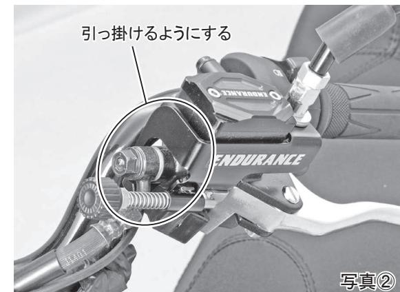
3. 前項1で取り外したミラーアダプターに付属のワッシャーをセットしてから、パーキングブレーキの穴に差し込み、パーキングブレーキを共締めするように仮止めします。(写真③)
