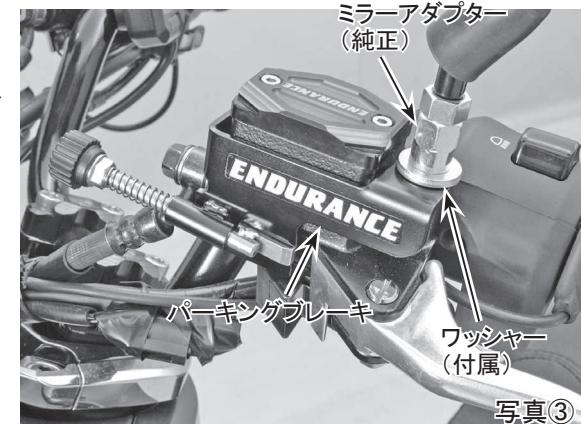
4. 前項3で仮止めしたパーキングブレーキをリザーバータンクの方へ寄せながらミラーアダプターで共締めしてください。(写真④)
