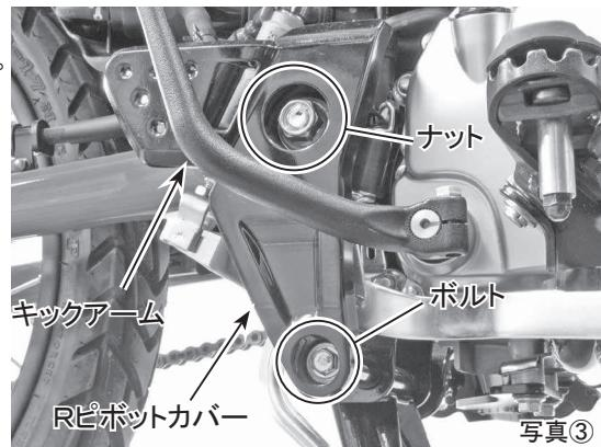
4. 前項③でbolt、ナットを取り外したRピボットカバーを写真④のように少し手前に浮かしながらサイドスタンドステーを裏側へ通します。
