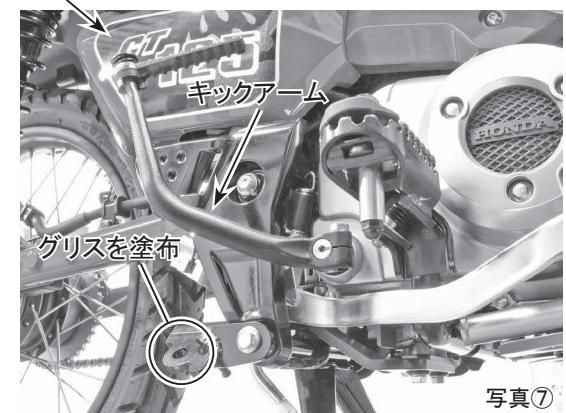
8. 前項⑦でグリスを塗布したところへサイドスタンド本体をセットし、付属のピボットボルトとナットで締め付けます。
