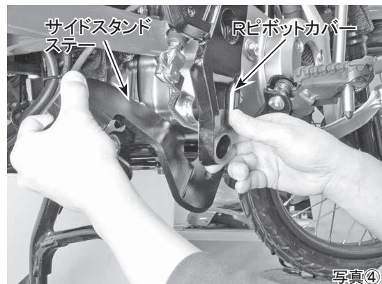
5. Rピボットカバー下側の前項③で取り外したbolt部分に、付属のbolt M8×45、ワッシャー、カラー(長い方)をセットし、サイドスタンドステーを仮止めします。また同様に、前項③で取り外した上側の純正ナットも仮止めしておきます。(写真⑤)
