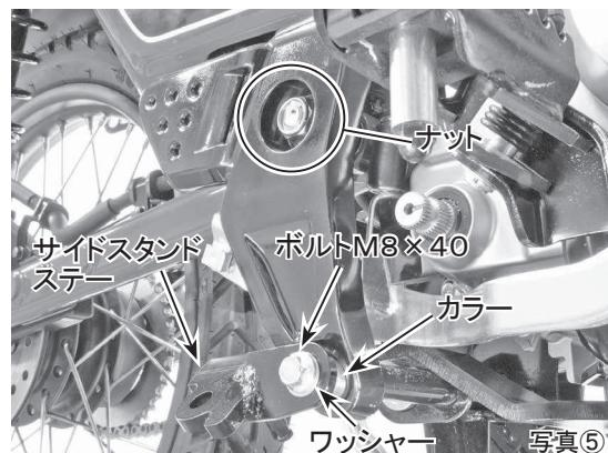
6. 前項①で取り外したbolt部分に仮止めしているサイドスタンドステーとエンジンとの隙間に付属のカラー2個(短い方)をセットし、それを付属のbolt M8×40と純正ワッシャーで仮止め後に、Rピボットカバー、エンジン下側の順に規定トルクにて締め付けます。(写真⑥、⑦)
