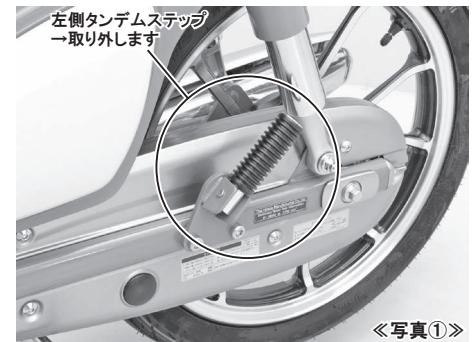
4. 前項3. で外したボルトの場所へ付属のローステーをキャップボルトM6×70、ワッシャー  $\phi 6 \times \phi 12 \times t1.0$ 、カラーをセットし、上側のボルトから少しづらした状態で仮止めします。
