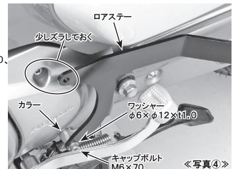
5. スプロケットカバー上側のボルトを取り外し、下側と同様にキャップボルトM6×70、ワッシャー、カラーをセットして仮止めします。
