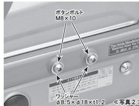
3. スプロケットカバーの下側のボルトを外します。
