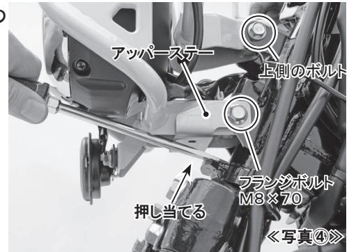
5. 前項④で締め付けたボルトに付属のナットを取り付け、規定トルクで締め付けます。この際もアップステーが下がってこないようにヘッドライトステーに押し当てながら締め付けます。
