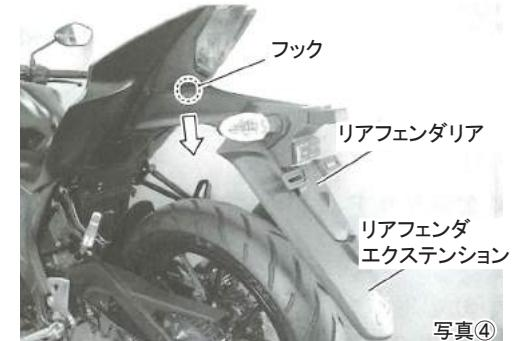
5. スクリュ（5ヶ所）、プラリベット（4ヶ所）を取り外して、リアフェンダエクステンションをリアフェンダリアから取り外します。
