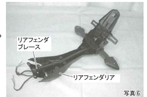
7. クランプ（1）を外して、左右のリヤターンシグナルランプ（2）およびライセンスプレートランプ（3）のリードワイヤをプロテクタチューブ（4）から抜きます。このときスクリュ（5）を外してライセンスプレートランプ（6）を取り外します。
