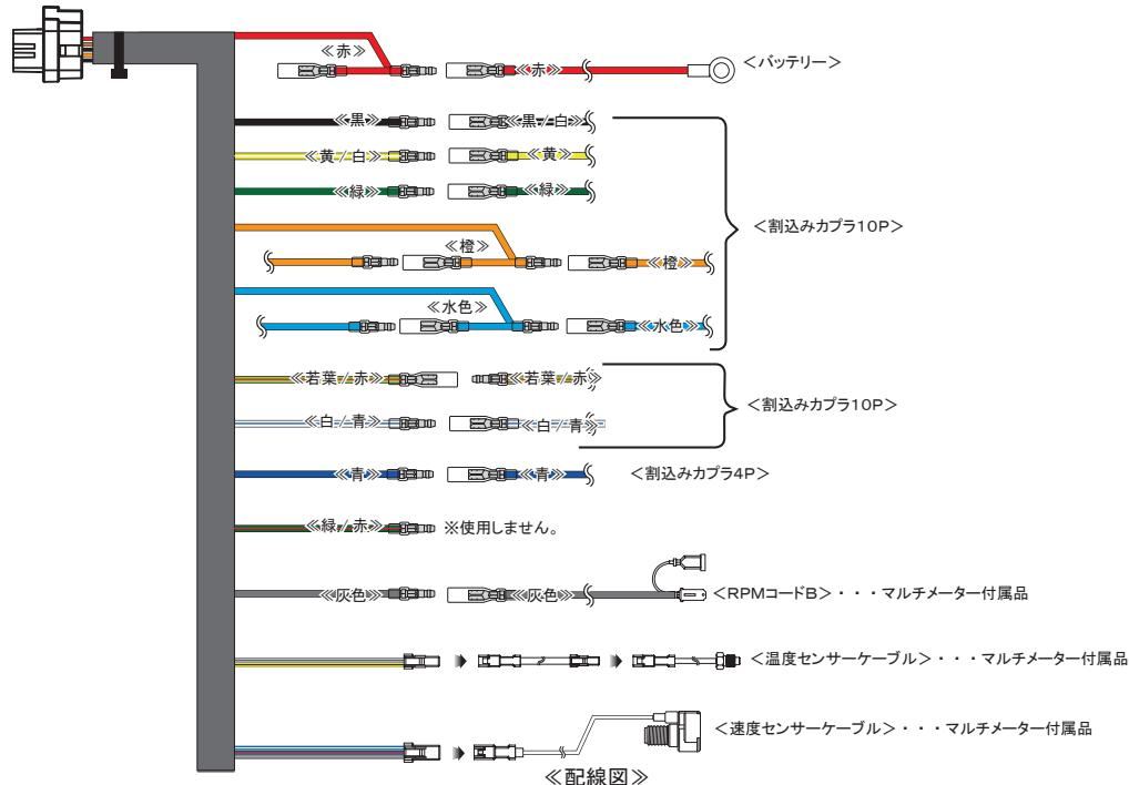
11. ギボシ端子を接続したら、配線を写真⑯のようにレイアウトしてタイラップなどで軽く固定します。
