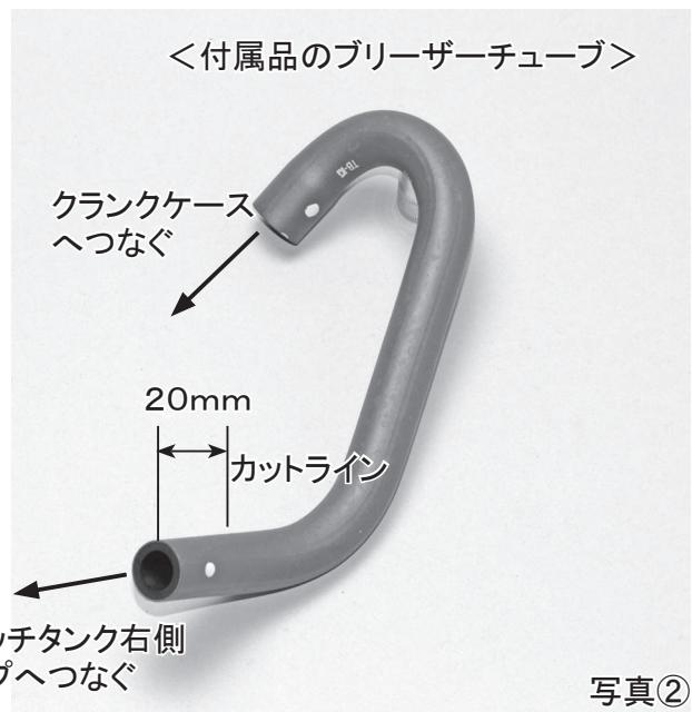
3. 写真③の位置にオイルキャッチタンクをタイラップにて固定します。また、ブリーザーチューブを付属のクリップ2個と車両から取り外したクリップ2個を使いエアクリーナー、クランクケースにつなぎます。ブリーザーチューブは差し込み部内側を脱脂してから差し込んでください。
