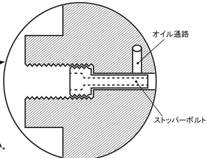
※オイルクーラーを使用する時のみストップボルトを取り付けて
