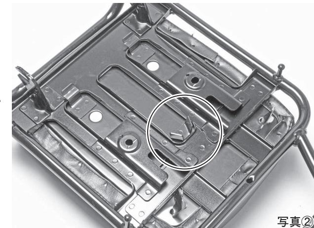
2. 写真②のようにタンデムシート裏側にある突起部がRrキャリアに合うようにします。
