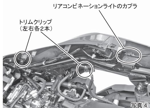
5. ハーネスを止めているクリップを2か所とボルトを2本取り外し、左右のボディカバーごとリアコンビネーションライトを後方へ引き抜くように取り外します。
