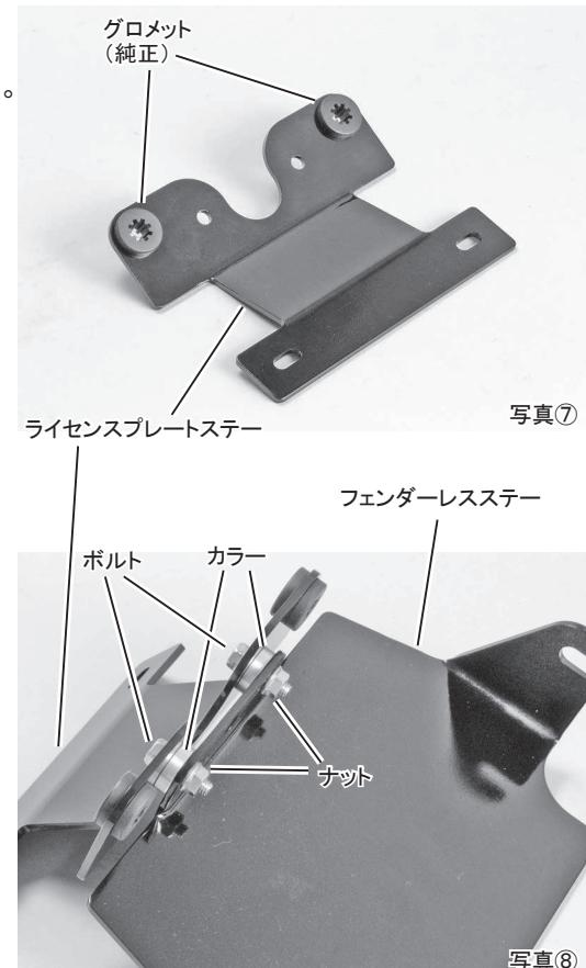
8. 前項⑦でグロメットをセットしたライセンスプレートステーとフェンダーレスステーの間に付属のカラーを挟むようにして、付属のボルト、ナットで締め付けます。(写真⑧)
