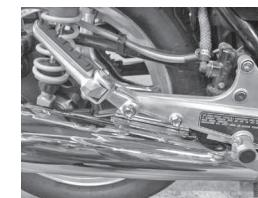
④口元の M6 ナットを締め付けます。
