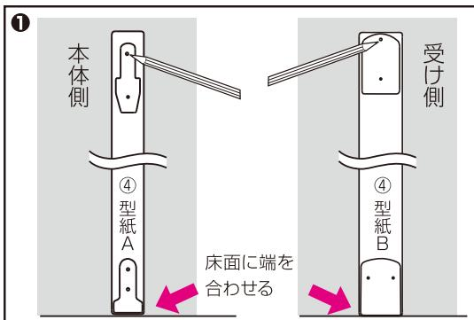
設置面に④型紙A、受け側に④型紙Bをあて、それぞれの下端が床にぴったり沿うように合わせ、ペンなどでネジ穴の目印をつけます。
