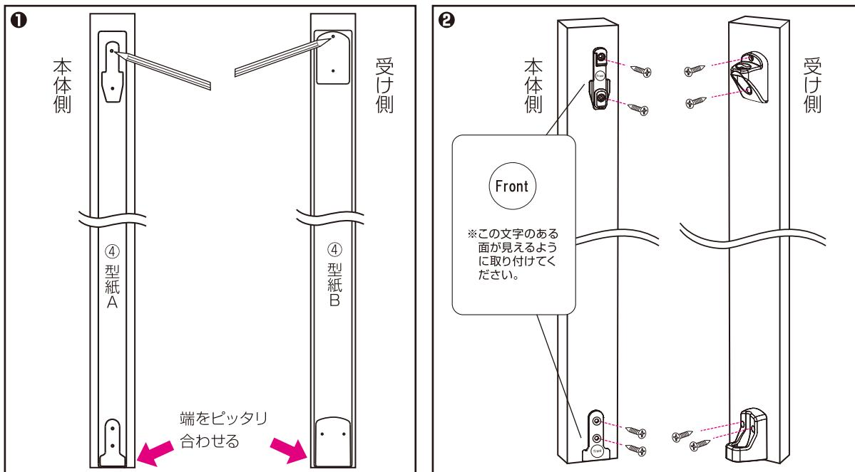
補助板に④型紙A、④型紙Bをあて、それぞれの下端がぴったり沿うように合わせ、ペンなどでネジ穴の目印を付けます。
