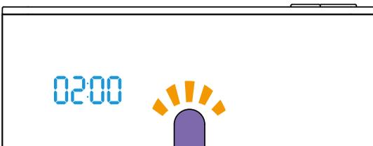
準備運転が開始すると共に、水位窓が紫に点滅、表示 LED に 0 2 : 0 0 と残り時間が表示されます。
