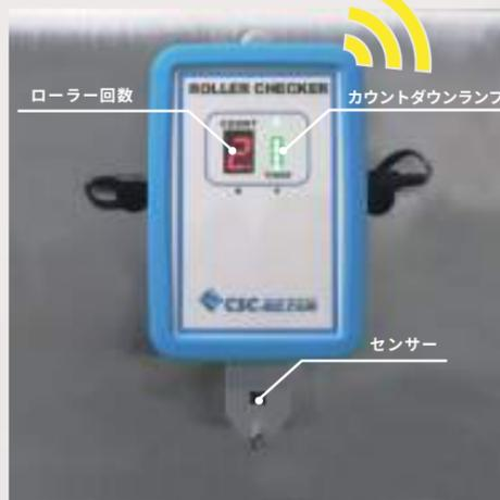
弊社が開発した「ローラーチェッカー」は、**持込ゴミ対策に欠かせない粘着ローラー掛けを管理するツール**です。ローラーをフックから取り外すとタイマーが作動し、**人によるローラー掛け時間のバラつきを防ぎます**。また、ローラーをフックに掛けるだけでローラーの残り使用回数(フィルムを剥がすタイミング)を自動カウントします。
