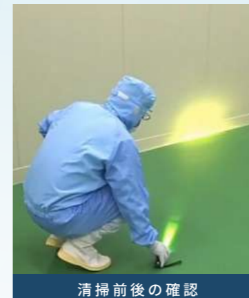
清掃前後にクリーンルームをミニNで確認すると、掃除の重要性がよくわかります。
