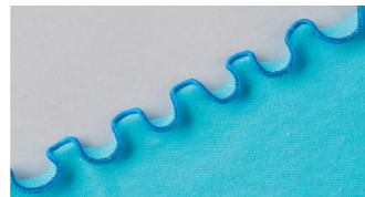
フリル縫い 伸縮地に差動と全巻き縫いを使って、デザイン性豊かな作品に仕上げます。
