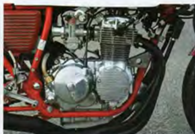
エンジンはヨシムラφ54.5mmピストンキットに408cc用クランク（ストロークは50mm）を組み合わせた466cc仕様だ。BRC製ビッグバルブ、ヨシムラST-1カムなど組みチューニング。CRスペシャルキャブ+BRC手曲げ管を組み合わせる
