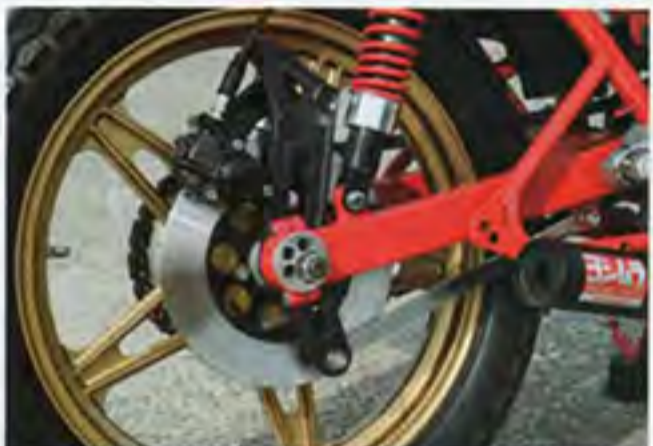
リアホイールもビモータ製で2.15-18。純正ではドラムだったリアブレーキはディスク化されている。スイングアームもビモータ製で、リヤショックにはコニの初期型ボディ、通称ウイングコニが装着されている
