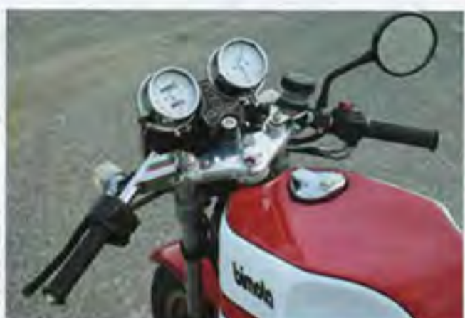
フロントフォークとステムまわりは純正のまま。メーターは、ホワイトパネル加工してBRC製メーターアップブラケットで装着位置を上方に移動する。無骨なデザインが特徴的なセパバはマーキング製をチョイスした
