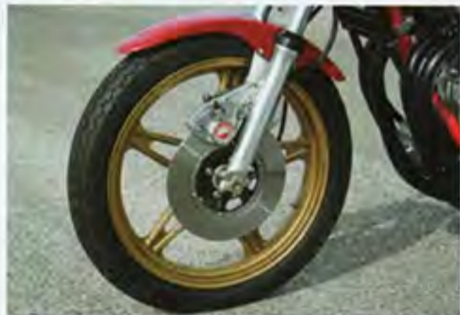
フロントキャリア周りにはマキシムのキットを組み込む。ホイールも当時モノの鍛造ビモータ製（純正ではスポークホイール仕様だ）で、サイズは2.15-18だ。撮影時のタイヤはダンロップTT100GPで3.00-18を履いていた
