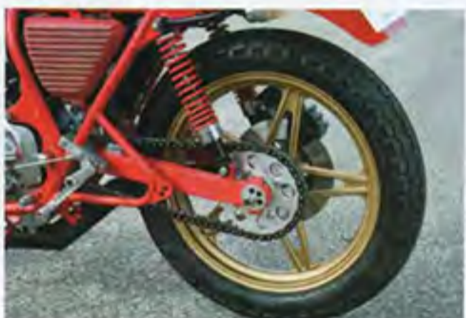
ドライブチェーンはFK製ブラックで、サイズも530化されている。隅に見えるステップもビモータ製。フレームはあえて補強もせず純正のまま。タンデムステップは外されるがステーは残り、純正仕様に戻せるのだ
