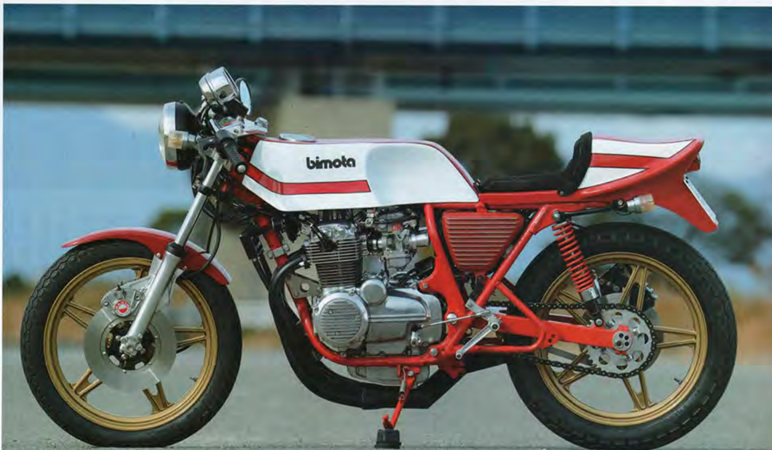
フロントキャリア周りにはマキシムのキットを組み込む。ホイールも当時モノの鍛造ビモータ製（純正ではスポークホイール仕様だ）で、サイズは2.15-18だ。撮影時のタイヤはダンロップTT100GPで3.00-18を履いていた
