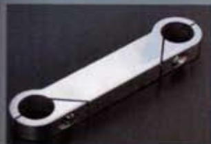
●CB400F アルミ 削り出しスタビライザー (バフ掛け)※鏡面仕上げ
