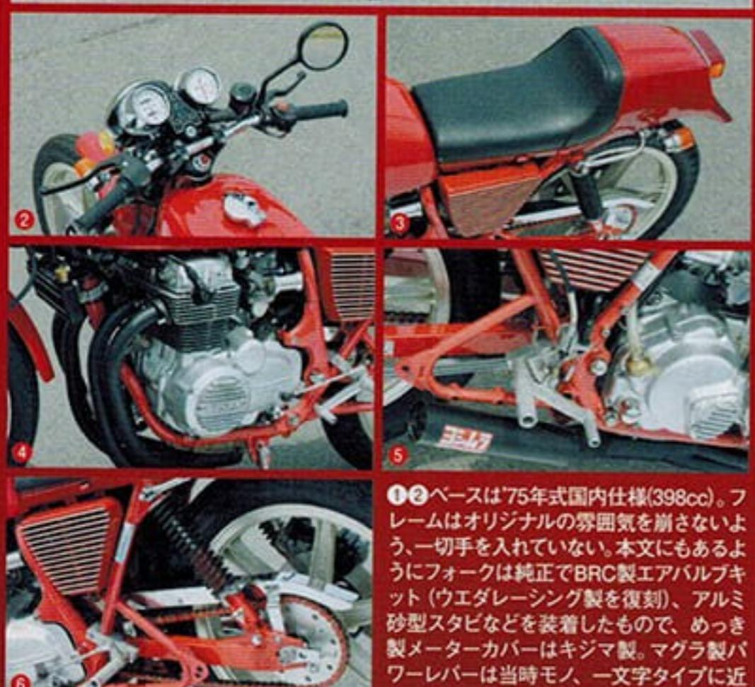
①②ベースは75年式国内仕様(398cc)。フレームはオリジナルの雰囲気を崩さないよう、一切手を入れていない。本文にもあるようにフォークは純正でBRC製エアバルブキット(エダレーシング製を復刻)、アルミ砂型スタビなどを装着したもので、めっき製メーターカバーはキジマ製。マグラ製バーレバーは当時モノ、一文字タイプに近いハンドルバーはヨンフォア純正だ
