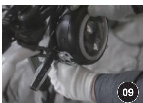
▶ 工具を使用し、ネジをしっかりと締めます。
