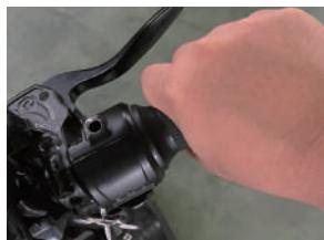
スロットルを回した時にスムーズに戻るか。※必ず電源を切った状態で行う事。
