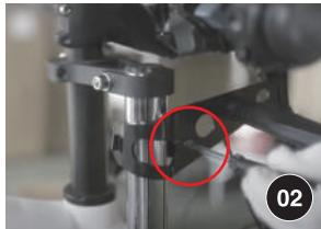
▶ 左右とも写真のネジをドライバーで締めます。
