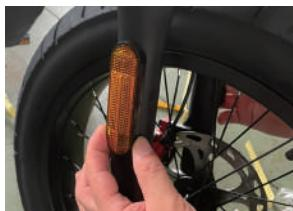
▶ 反射板は写真のように左右貼り付けます。
