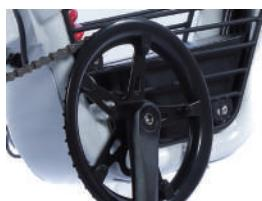
バイクを押し歩いた際クランクの作動は正常か。※前進した際、クランクは回らない。後退した際、クランクは回る。
