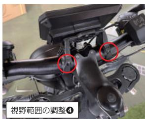
▶ その後、ディスプレイ等各操作パーツの角度調整は、それぞれ固定されているネジを緩めて調整してください。
