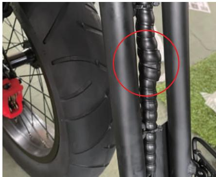
48Vの変換元コネクタは前方フレーム下にある螺旋状の配線カバー内にございます。(コネクタは絶縁テープで保護されています)
