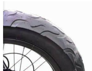
⑫ タイヤに布目が見えるような深いキズがないこと、接地面の模様が十分残っていることを確認する(残溝1mm以上)。
