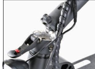
④ハンドルポストの高さ調整レバーは確実に固定されていることを確認する。
