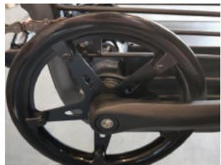
⑭ 電源入った状態で電動バイクを押し歩く際、クランクは車輪回りのペースで回ることはないかを確認する。
