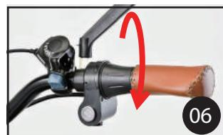
▶ スロットルを回すと、電動モード走行します。
