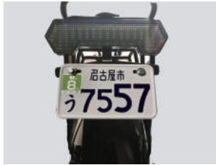
⑬ ナンバープレートはフェンダーと接触ないように両サイドの固定用ネジをしっかりと調整・固定されるかを確認する。※ナンバープレートとフェンダーとの接触はフェンダーを傷つけ、走行中接触音・フェンダーフックの原因になります。
