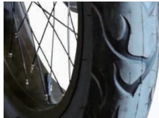
⑪ タイヤに十分空気が入っていて、空気圧はタイヤに記載した気圧範囲内になっていることを確認する。
