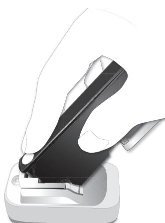
端子と IC チップの金属部が正しく接触した状態で、カートリッジをリセッターに軽く押しつけ、端子が 1mm 程度押し込まれると IC チップの書き換えが始まります。
