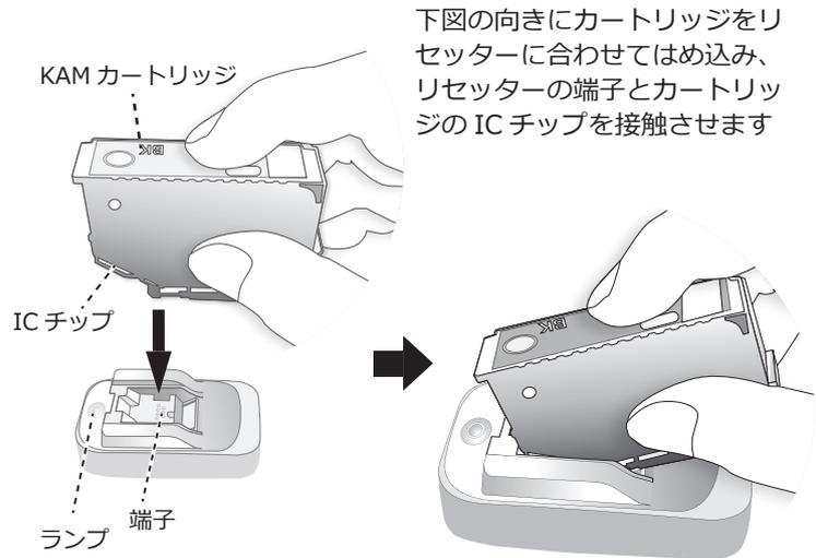
下図の向きにカートリッジをリセッターに合わせてはめ込み、リセッターの端子とカートリッジのICチップを接触させます
