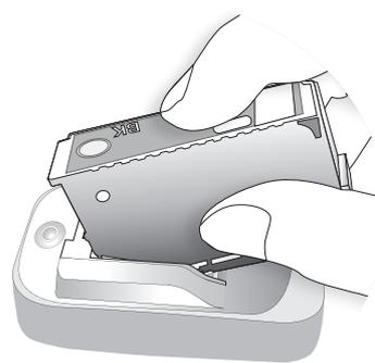
端子と IC チップの金属部が正しく接触した状態で、カートリッジをリセッターに軽く押しつけ、端子が 1mm 程度押し込まれると IC チップの書き換えが始まります。ランプが緑色に点灯すれば正常終了です。端子と IC チップの金属部が正しく接触していないとランプは点灯しません。その場合は、一旦端子を離し、再度②～③の手順を実行してください。
