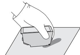
インク出口を下に向け、インク出口から少し上のカートリッジの腹をつまんで、余分なインクをインク出口から絞り出します。インク出口を下に向かたまま2、3分放置します。インクが垂れないことを確認し、プリンターに取り付けます。
