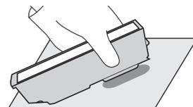
インク出口を下に向け、インク出口から少し上のカートリッジの腹をつまんで、余分なインクをインク出口から絞り出します。インク出口を下に向けたまま2、3分放置しします。インクが垂れないことを確認し、プリンターに取り付けます。
