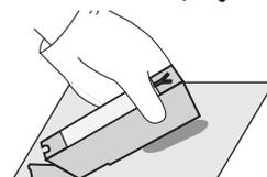
インク出口を下に向け、インク出口から少し上のカートリッジの腹をつまんで、余分なインクをインク出口から絞り出します。インク出口を下に向けたまま 2、3 分放置します。インクが垂れないことを確認し、プリンタに取り付けます。
