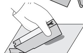
インク出口を下に向け、インク出口から少し上のカートリッジの腹をつまんで、余分なインクをインク出口から絞り出します。インク出口を下に向けたまま 2、3 分放置しします。インクが垂れないことを確認し、プリンタに取り付けます。
