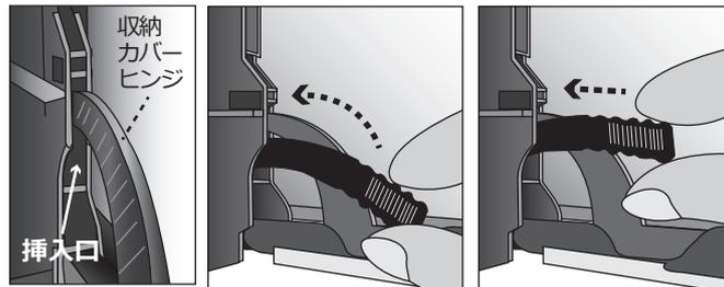
【D型】 プリンタ本体の挿入口からセンサーキーパーを挿入してください。
